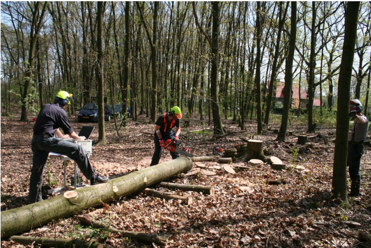
Figuur 1: illustratie van de uitvoering van de meting van de blootstelling aan trillingen bij gebruik van een motorkettingzaag in de praktijk.
