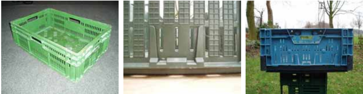
Naarmate het oppervlak gladder en vlakker is, is de reinigbaarheid beter. Profielen (foto links) vergroten het te reinigen oppervlak en veroorzaken lastig te reinigen hoeken. Reliëf (foto midden) ziet er degelijk uit, maar is slecht voor de reinigbaarheid. Dat doet ook het mechanisme van klapkratten (foto rechts)
