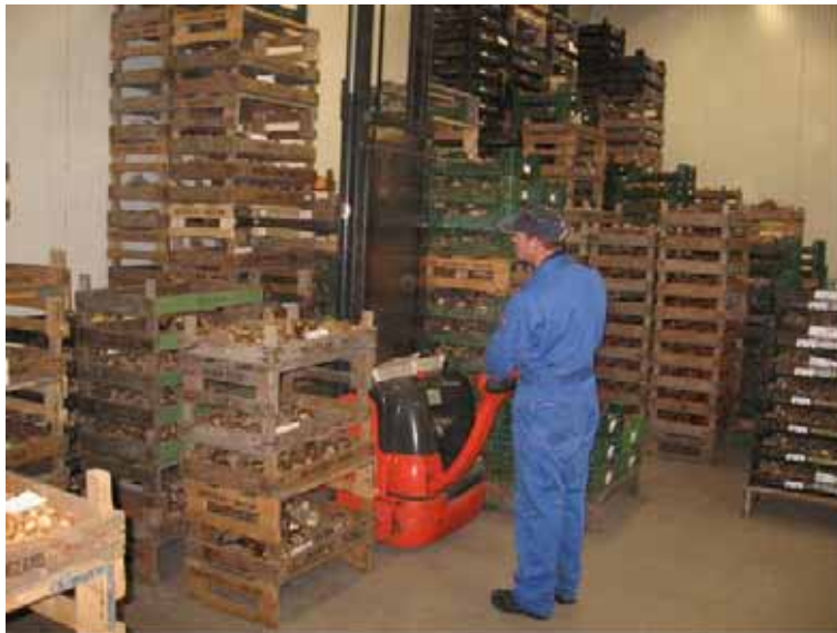
Interne verplaatsingen in de koelcellen met een aangedreven palletwagen met hefmast. Partijen zijn gescheiden door middel van een onderzetter in de stapel.
