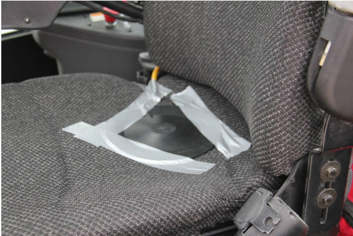
Figuur 1: illustratie bij de meting van lichaamstrillingen op de stoel van de heftruck: de opnemer voor trillingen is op de stoelzitting vastgezet met bouwtape.
