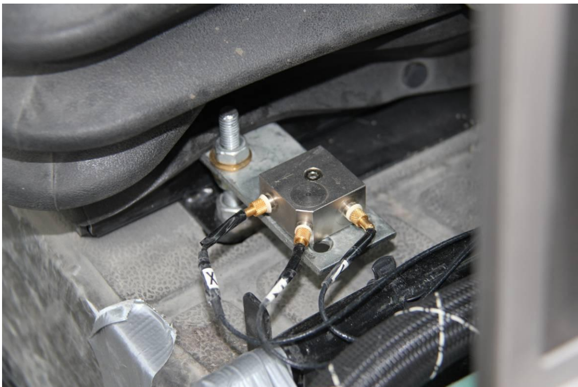
Figuur 2: illustratie bij de meting van trillingen van het chassis onder de stoel van de heftruck: de opnemer voor chassisstrillingen aan de stoelbasis is vastgezet op de plaats van een stoelbout.
