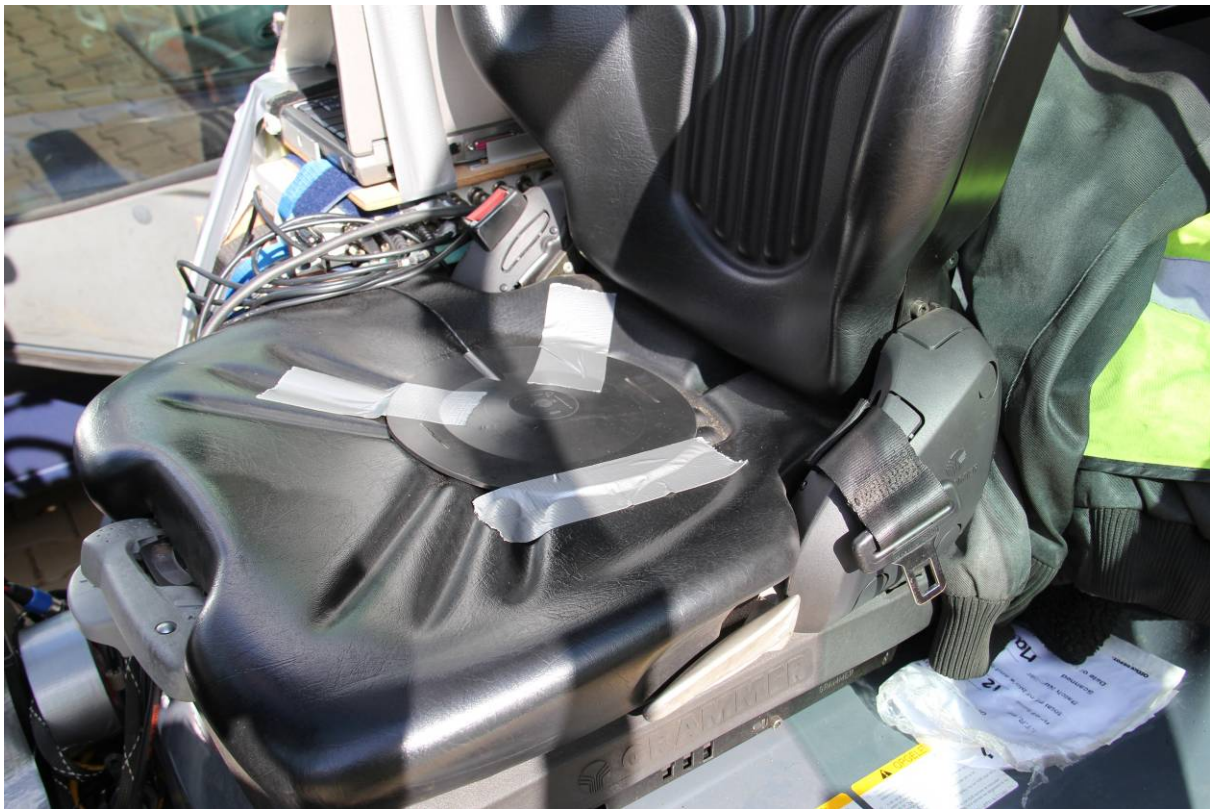
Figuur 1: illustratie bij de meting van trillingen tijdens rijden met een heftruck: montage van de opnemer voor trillingen op de stoelzitting.
