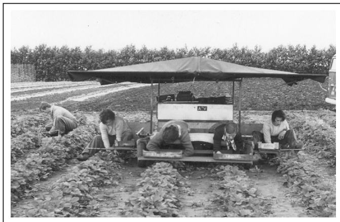
Figuur 2: In het verleden is al geëxperimenteerd met zelfrijdende constructies met verschillende typen werkbedden. De ondersteuning van het lichaam liet echter te wensen over.
