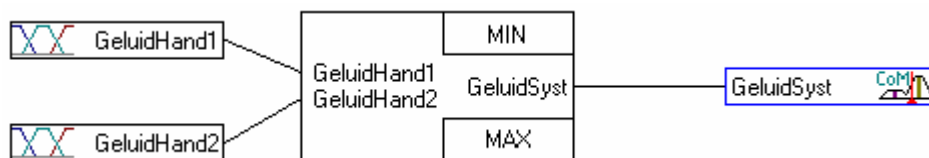
Figuur 29 Fuzzy-logicstructuur van combinatie van twee individuele handelingen met geluid. Figure 29 Fuzzy logic structure of the combination of two actions with noise.
