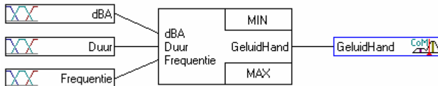
Figuur 28 Fuzzy-logicstructuur van beoordeling van een individuele handeling met geluid. Figure 28 Fuzzy logic structure of the assessment of one action with noise.
