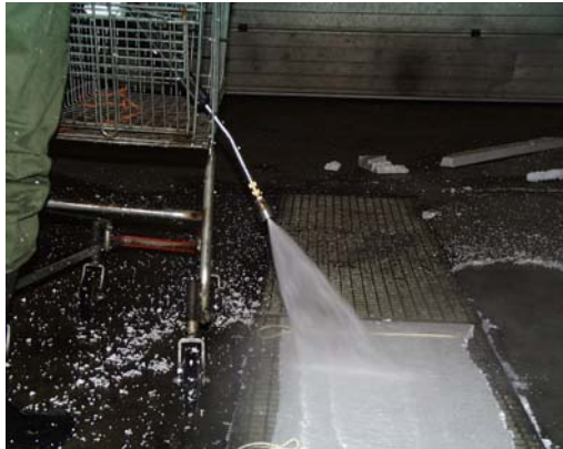
Figuur 4: Meetopstelling ter bepaling van het reinigend vermogen van de spuitopstellingen
