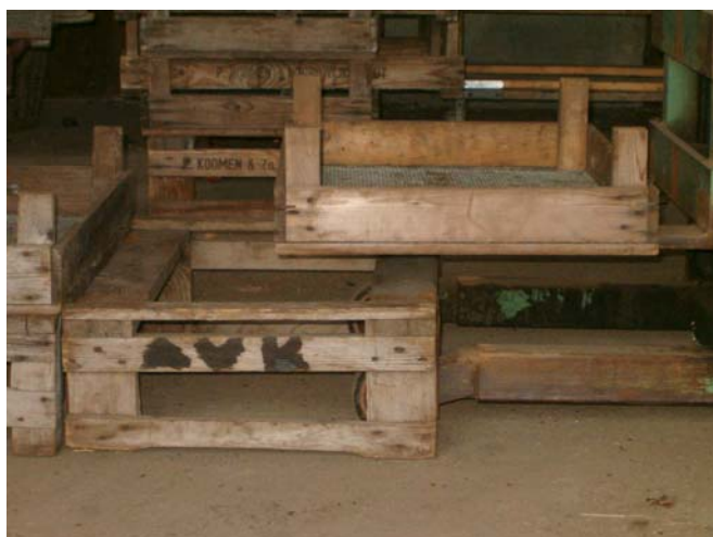
Figuur A2: Gaasbak wordt mechanisch van 'onderzetter' getild. Het afnemen van de onderste bakken is problematisch als de lepels niet onder de kist kunnen komen. De onderzetter moet dan worden aangepast, bijvoorbeeld door er een lat op te slaan.
