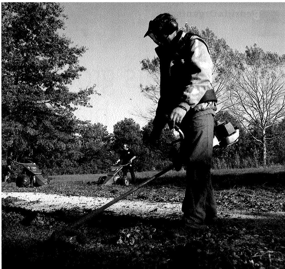
De eenassige trekker en de bosmaaier veroorzaken hand-armtrillingen. Om binnen de norm te blijven, zou de duur van de arbeid moeten worden beperkt.
