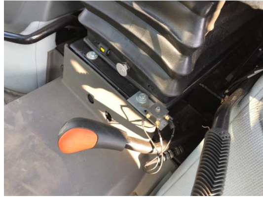
Figuur 2: illustratie van de bevestiging van de accelerometers op de stoel (linksboven) en aan de stoelbasis (rechtsboven). Tevens is geïllustreerd hoe de meetinstrumenten in een standaard kist achter de trekker worden meegevoerd (links onder).
