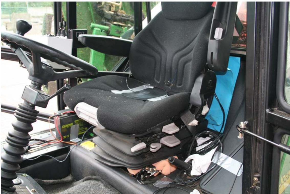
Figuur 1: illustratie bij de meting van lichaamstrillingen bij een maaimachine: montage van de opnemer voor lichaamstrillingen op de stoelzitting en de opnemer voor chassistrillingen aan de stoelbasis.
