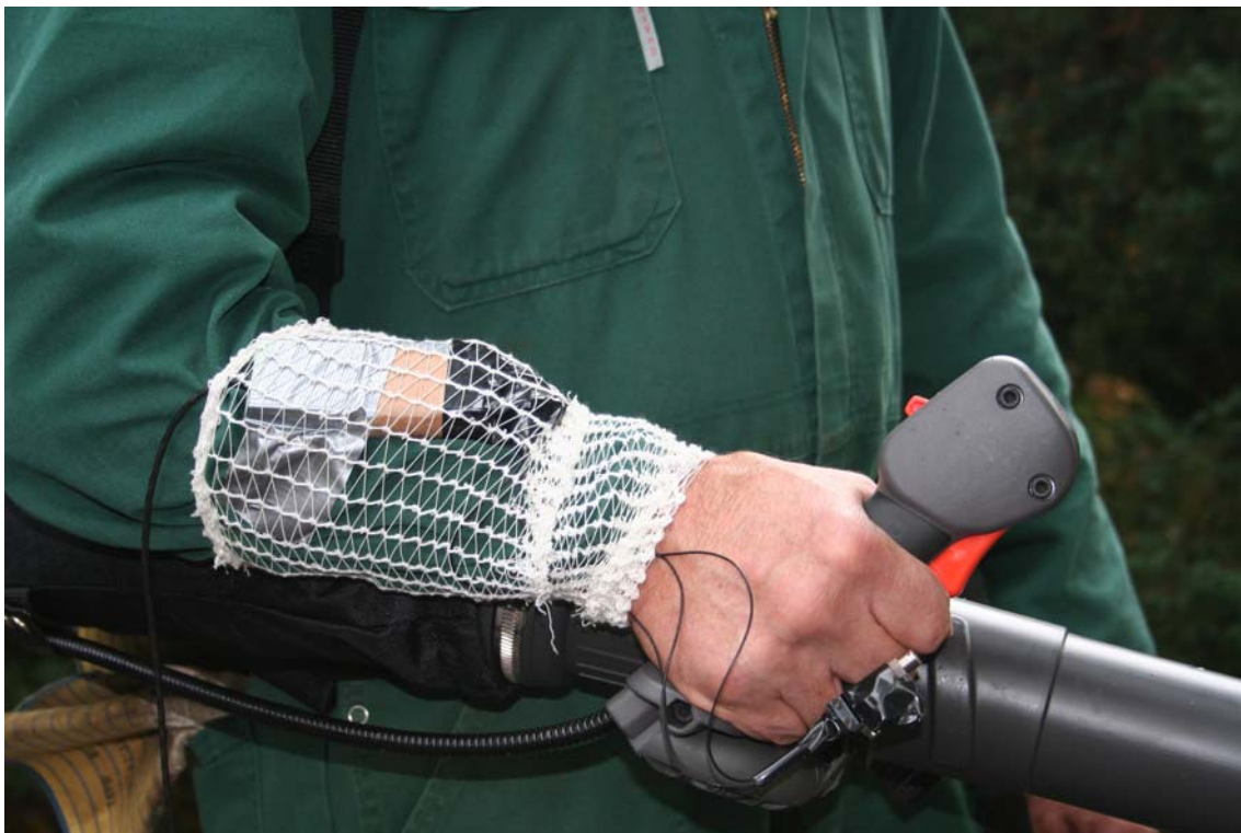
Figuur 2: illustratie bij de meting van hand-arm trillingen tijdens het hanteren van een bladblazer: de opnemer voor hand-arm trillingen geklemd op het handvat.
