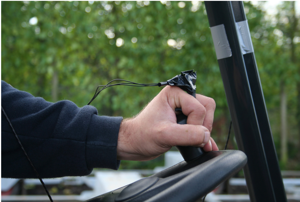
Figuur 2: illustratie bij de meting van trillingen tijdens rijden op een bestruck: de opnemer voor hand-arm trillingen geklemd op de stuurknobbel.
