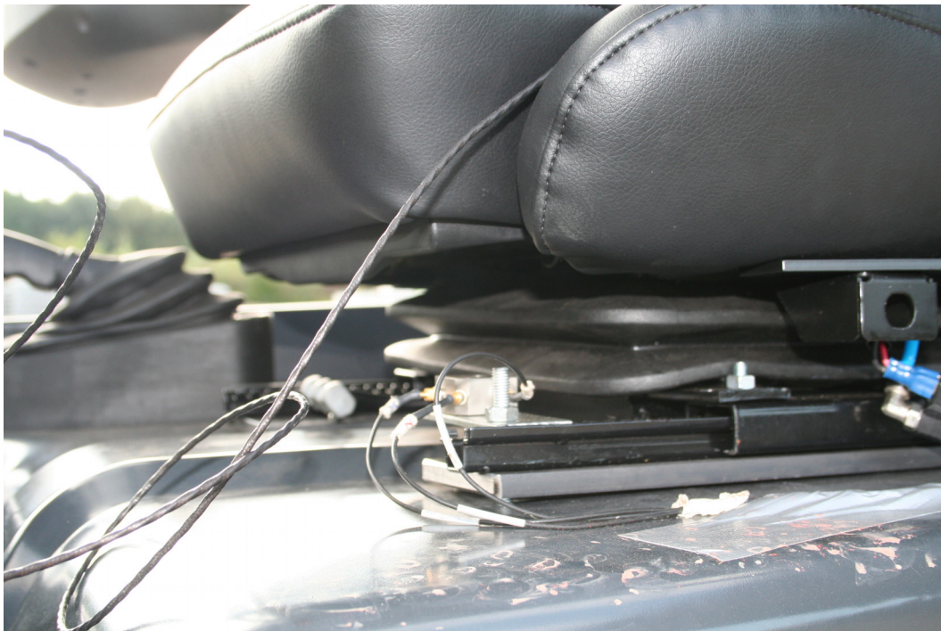
Figuur 3: illustratie bij de meting van trillingen tijdens rijden op een bestruck: montage van de opnemer voor chassistrillingen aan de stoelbasis.
