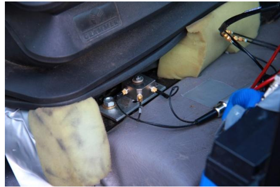
Figuur 4: Illustratie bij de meting van trillingen van de stoelbasis van de maaimachine: de opnemer voor trillingen aan de stoelbasis is vastgezet op de plaats van een stoelbout.
