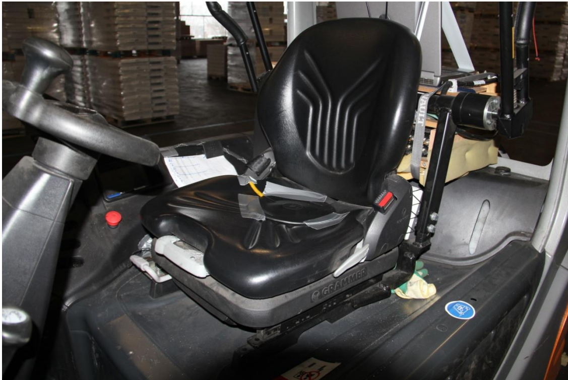
Figuur 2: Illustratie bij de meting van lichaamstrillingen op de stoel van de bestruck: de opnemer voor trillingen is op de stoelzitting vastgezet met bouwtape.
