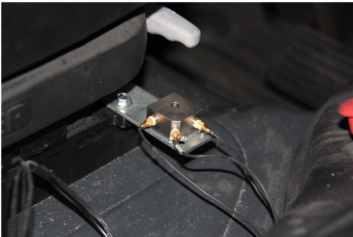
Figuur 3: illustratie bij de meting van trillingen van het chassis onder de stoel van de bestruck: de opnemer voor chassistrillingen aan de stoelbasis is vastgezet op de plaats van een stoelbout.
