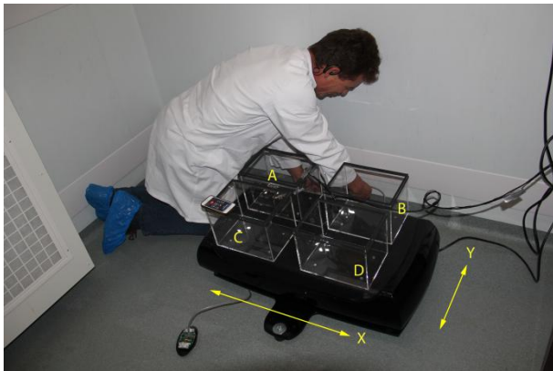
Figuur 1: meetopstelling waarin aangegeven de posities A-D van de triaxiale opnemer en de gehanteerde trillingsassen X en Y.
