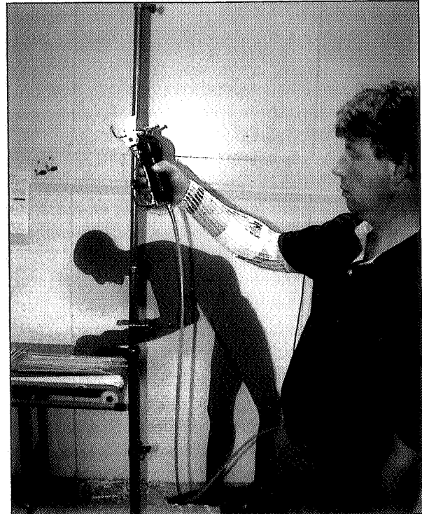
Figuur 1 Meetopstelling in het laboratorium. Aan de metalen paal werd het rondhout op twee hoogten gefixeerd (hier: ooghoogte).
