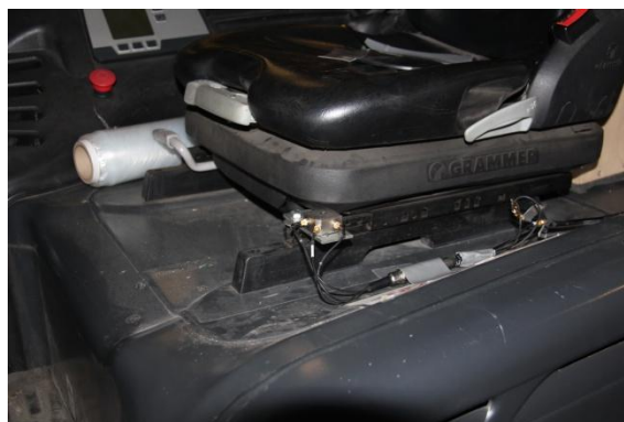
Figuur 2: Illustratie bij de meting van trillingen van de stoelbasis van de heftruck: de opnemer voor trillingen aan de stoelbasis is vastgezet op de plaats van een stoelbout.
