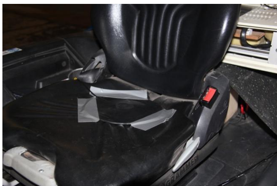
Figuur 1: Illustratie bij de meting van lichaamstrillingen op de stoel van de heftruck: de opnemer voor trillingen is op de stoelzitting vastgezet met Duct tape.
