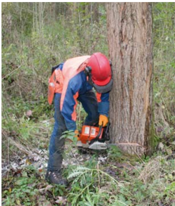
Figuur 1. In de bosbouw, hier het vellen van een populier, wordt veel gewerkt met antivibratiehandschoenen met als doel de blootstelling aan trillingen door de motorkettingzaag te verminderen. (foto: Anton Looije, A&E Wageningen)
