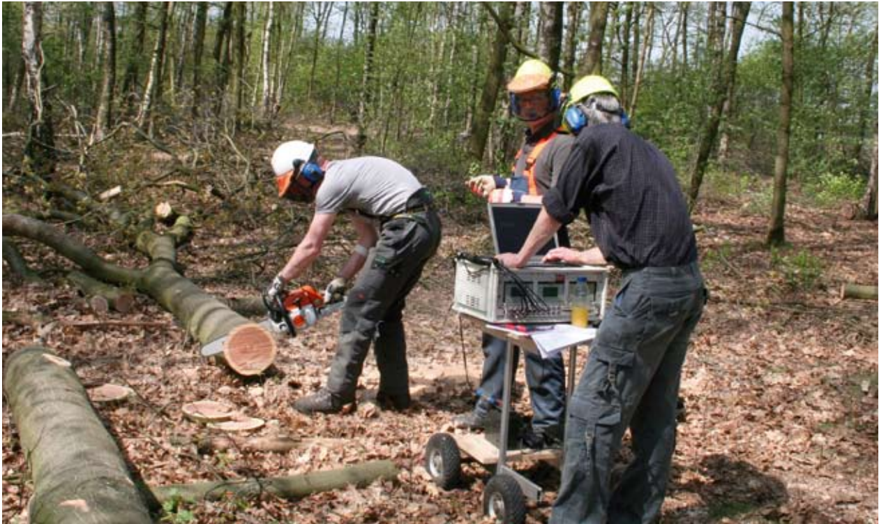
Figuur 2. Meting van hand-armtrillingen tijdens werkzaamheden in de praktijk. Om de effectiviteit van de demping van de handschoenen te bepalen moeten trillingen zowel aan het handvat buiten de handschoen als aan de hand in de handschoen worden gemeten. (foto: Anton Looije, A&E Wageningen)
